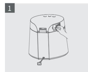
ボタンを押してフィルターカバーを外し、フィルターを取り外します。
