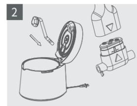
2 振動子をヒンジに合わせて取付けてください。
